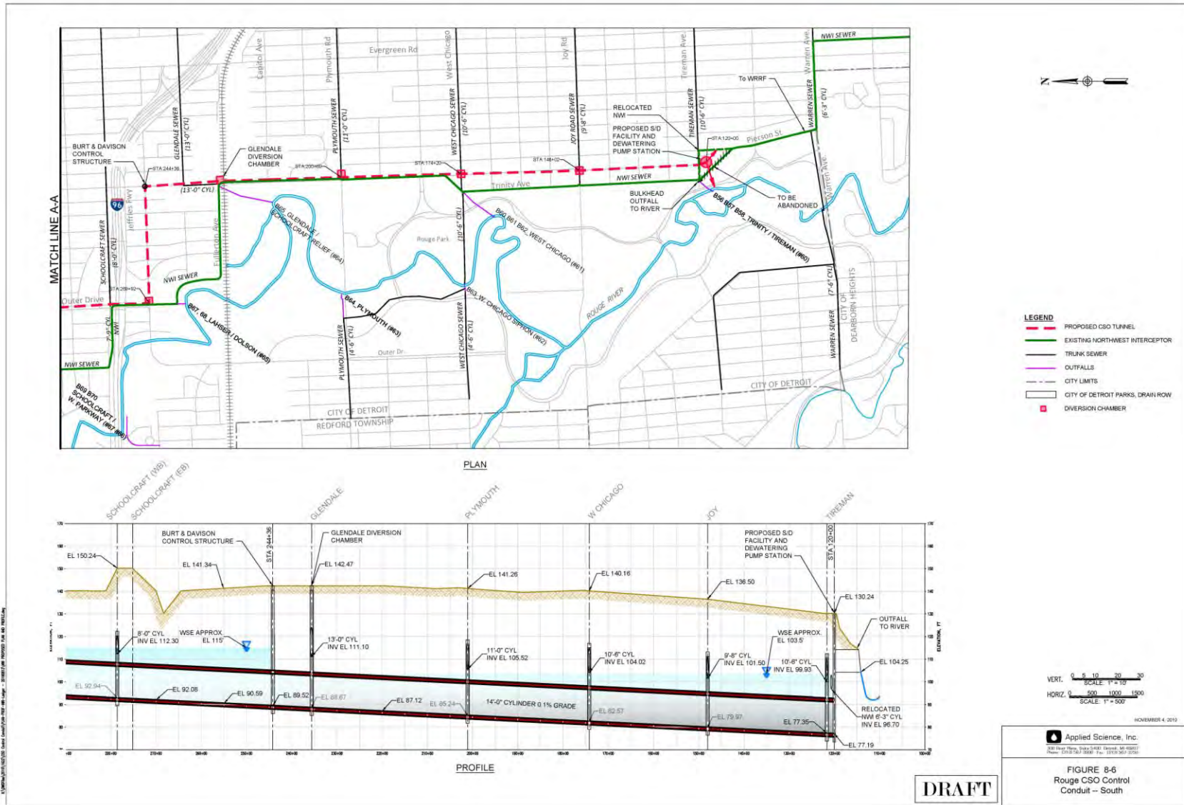
Figure 8-6. Rouge CSO Control Conduit -- South
